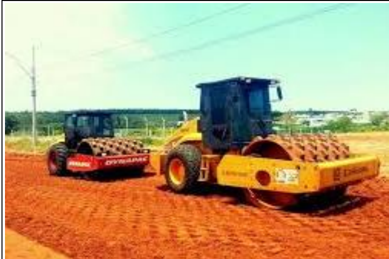
Equipamentos para compactação - Rolo pé de carneiro
