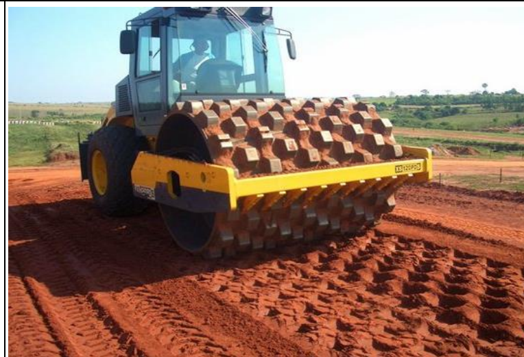
Equipamentos para compactação - Rolo pé de carneiro
