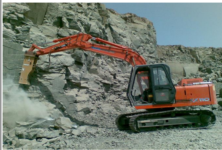
Equipamentos para desmonte de rocha (3ª categoria) - Escavadeira hidráulica com rompedor hidráulico
